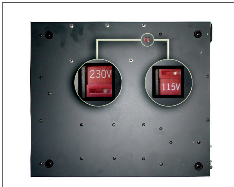
Figura 5.1: interruttore cambia tensione sulla parte sottostante URPT/MIC
