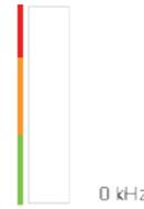
I livelli degli ingressi dei canali e modulazione vengono rappresentati tramite barre verticali situate nella parte destra del campo.
